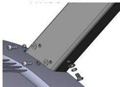
Step2: Вставьте компьютер в вертикальную стойку, закрепите его винтами M10\*20 ① с шайбами ⑤.
